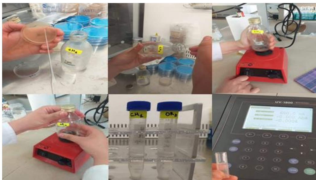
Figure 13 : Préparation de la suspension bactérienne
