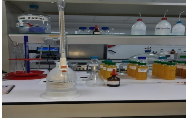
Figure 10 : Méthode de titrage de l'acidité au laboratoire R&D
