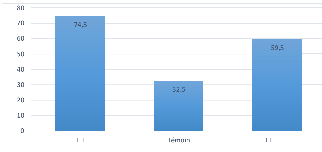
Figure III.1 : dureté HRC des différents échantillons : Témoin ; TL : Traitement laser ; TT : Traité thermiquement.
