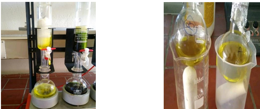
Figure 11 : Extraction l'huile végétale de Pistacia lentiscus par soxhlet (Photographie).
