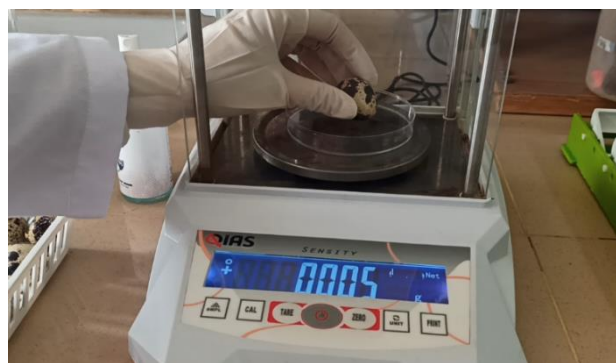
Figure 12 : Pesée d'un œuf de caille sur la balance analytique (QIAS SENSITY) ( Original, 2022 ).
