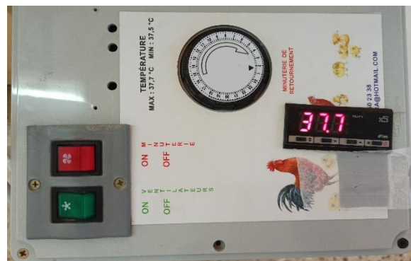
Figure 15 : Panneau de réglage de la ventilation, de la température et de la rotation de l'incubateur ( Original, 2022 ).
