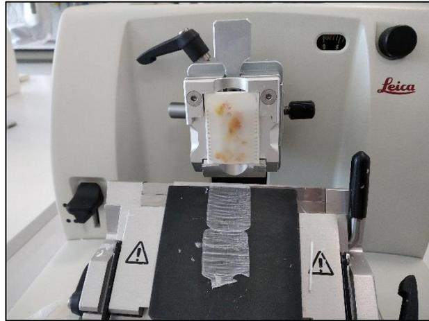
**Figure 38:** Coupure des blocs au microtome (**Originale**).
