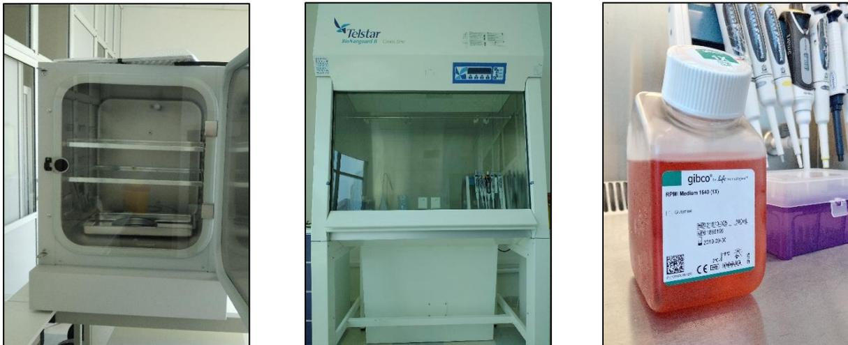
**Figure 1:** Appareillage et matériaux utilisés en culture cellulaire (**Originale**). **A gauche**, Incubateur à CO<sub>2</sub>. **Au milieu**, Poste de Sécurité Microbiologique (PSM). **A droite**, milieu de culture.
