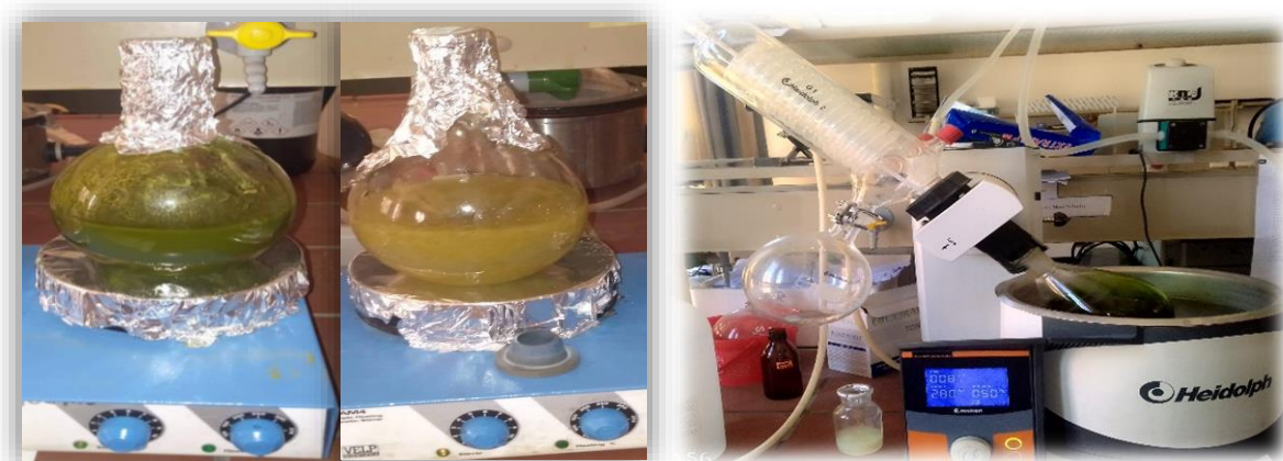
Figure 12 : Extraction éthanolique par macération et séchage au Rotavapeur
