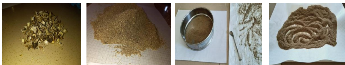
Figure 7: Récupération de la poudre obtenue après broyage et tamisage ( Madani et Redouane, 2022 ).
