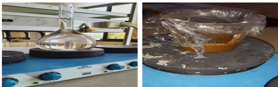
Figure 10 : Mélange poudre séchée + NaOH mis sous agitation (Madani et Redouane, 2022).
