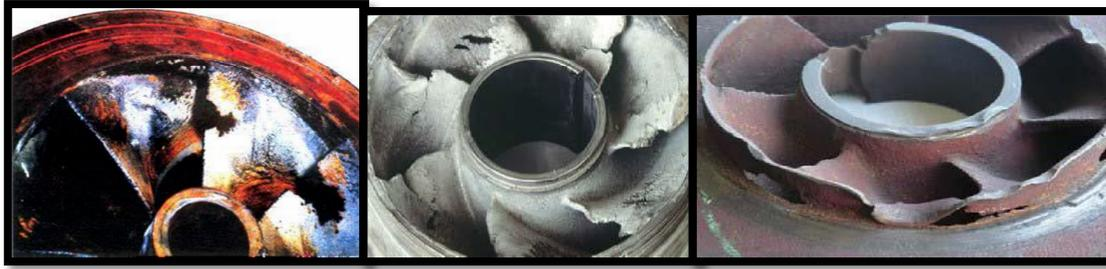
*Figure V. 7 : Érosion par cavitation sur les aubes d'une pompe centrifuge*
