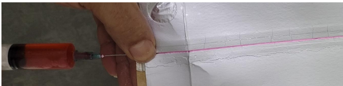
Figure 11. Injection de l'encre rouge à l'aide d'une seringue dans le canal d'air présent dans la soudure longitudinale
