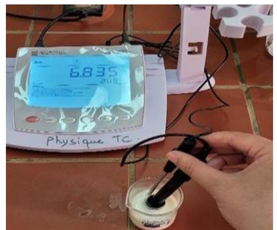
Figure 14. Mesure du pH du lait à l'aide d'un pH-mètre
