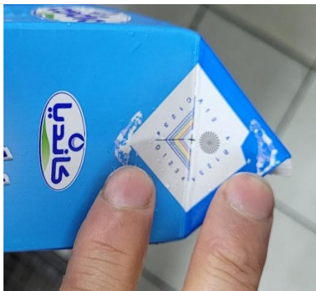
Figure 9. Vérification de la soudure Des cornes.
