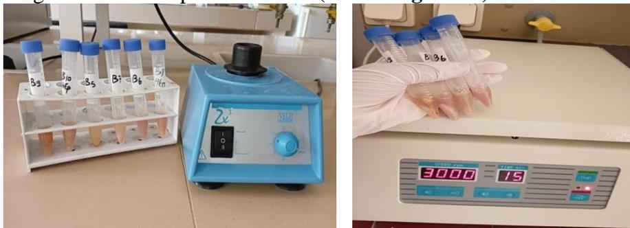
**Figure 23 :Agitation et Centrifugation de la suspension**
