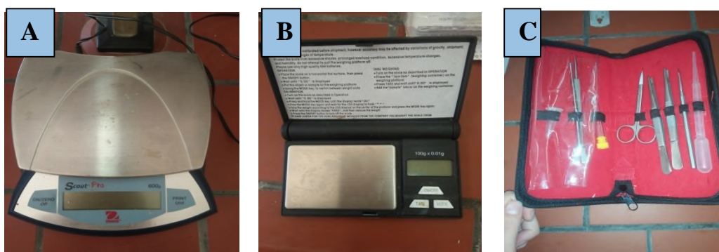
Figure 05 : les photos illustrant le matériel utilisé pour la biométrie et la dissection des poissons . A : balance de précision (OHAUS Scout Pro 600g) ; B :balance de précision (OHAUS Corporation USA YA102 100g*0.01g) ; C : trousse de dissection.
