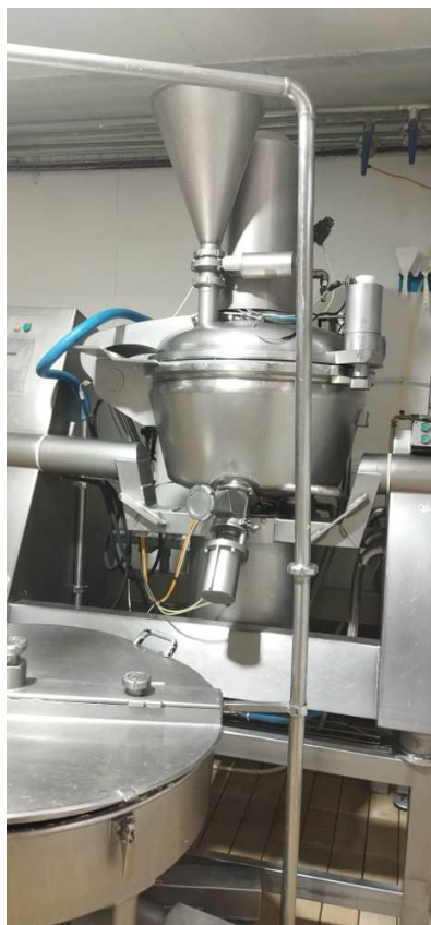
Illustration du cuiseur STEPHAN et le chariot de transfert (étape cuir et pasteuriser et transfert vers le chariot)
