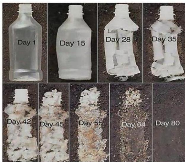
**Figure 20** : Biodégradation en bouteille en PHA, par incubation dans la boue pendant 80 jours (Sudesh *et al.*, 2000).
