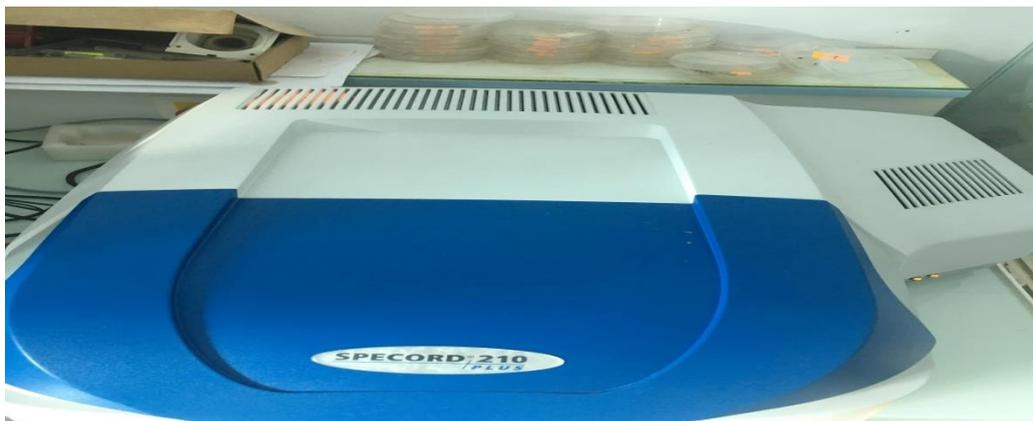
**Figure 20** : Mesure de l'absorbance avec le spectrophotomètre
