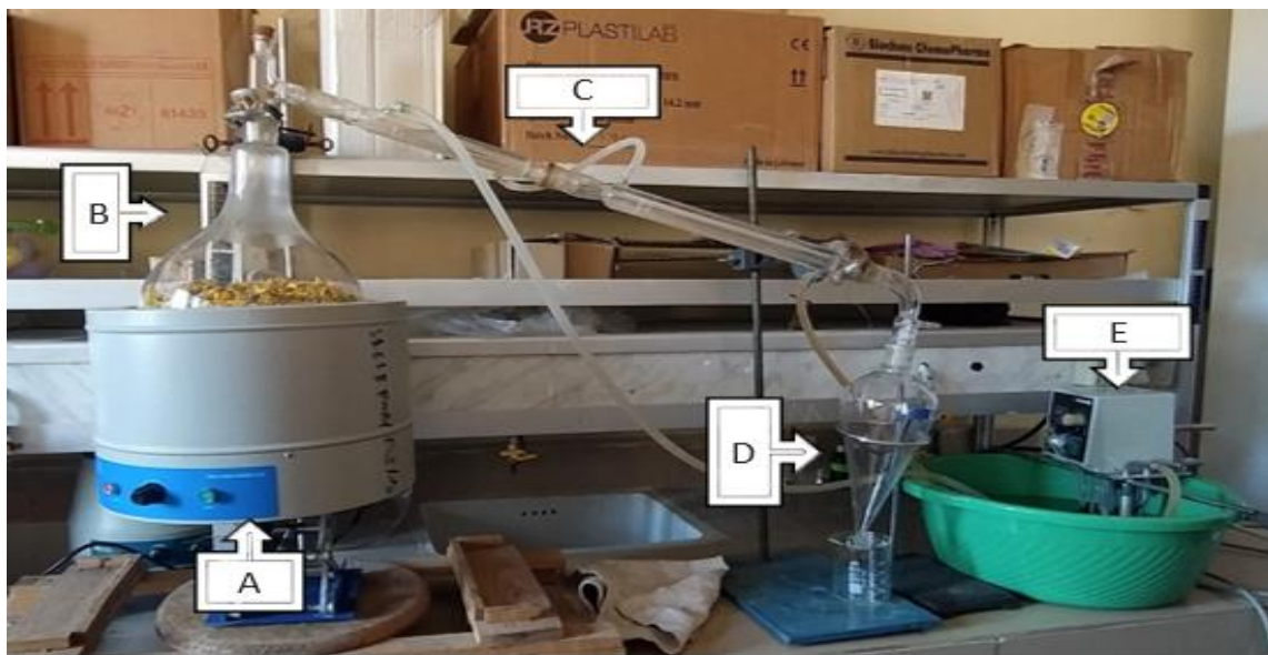
Figure 29: figure représentant le mécanisme d'hydrodistillation utilisée, (A) Source de chaleur, (B) Ballon d'ébullition, (C) Condenseur, (D) Ampoule à décanter, (E) Pompe d'eau (originale 2023)
