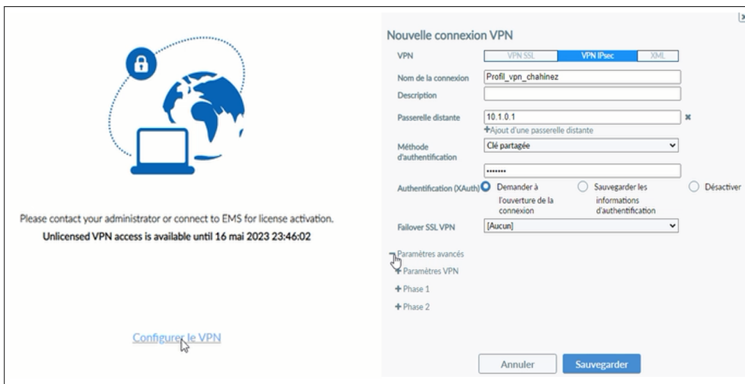
FIGURE V.47 – Configuration d'une connexion VPN.
