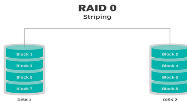
FIGURE IV.5 – Graphique illustrant l'ensemble du concept RAID 0 [15].
