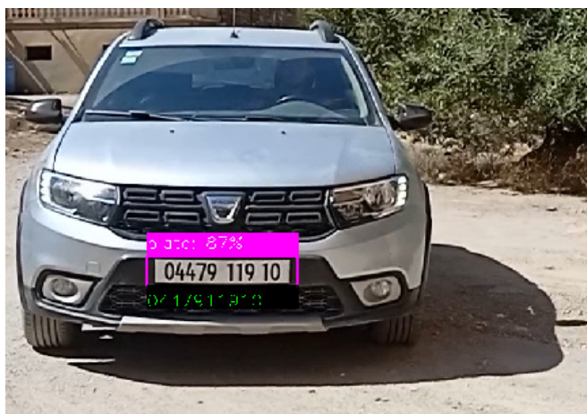
Figure V- 6 Résultat d'une détection d'une plaque d'immatriculation pour une voiture
