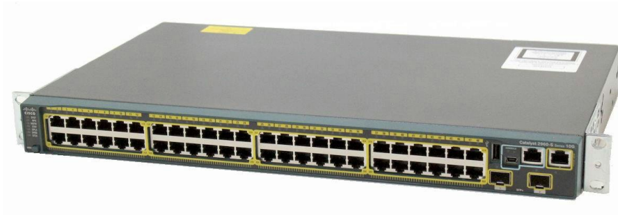
FIGURE 2.5 – Switch d'accès Cisco Catalyst 2960[13] .
