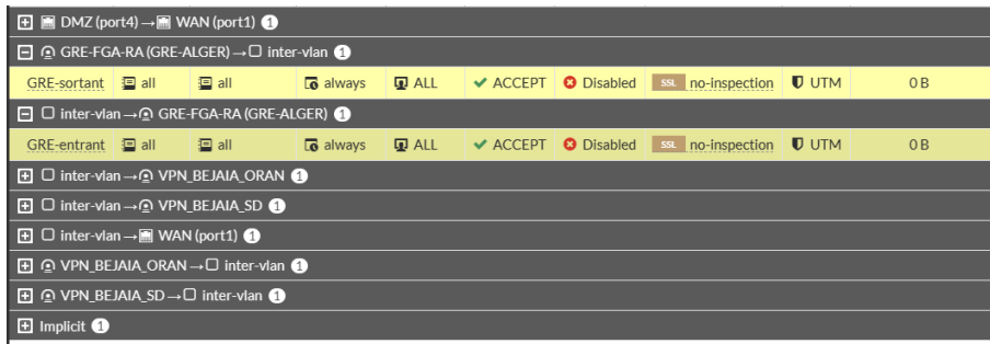
FIGURE 4.67 – politique de sécurité GRE dans le pare-feu.
