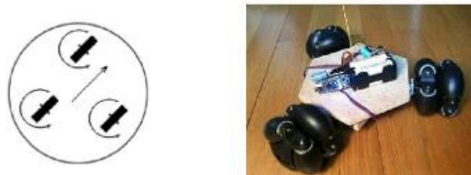
Figure I. 9 Robot de type omnidirectionnel
