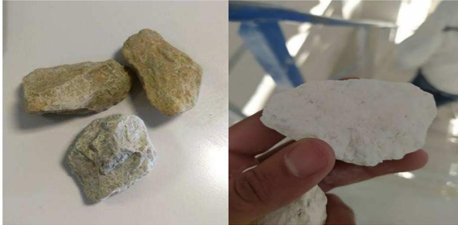
*Figure 10 : la classe de 40 mm à 70 mm avant et après calcination.*
