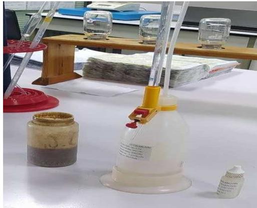
*Figure 16 : Mesure de l'alcalinité du jus chaulé.*
