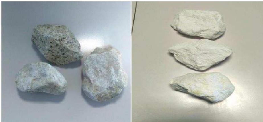
*Figure 9 : la classe de 0 mm à 40 mm avant et après calcination.*
