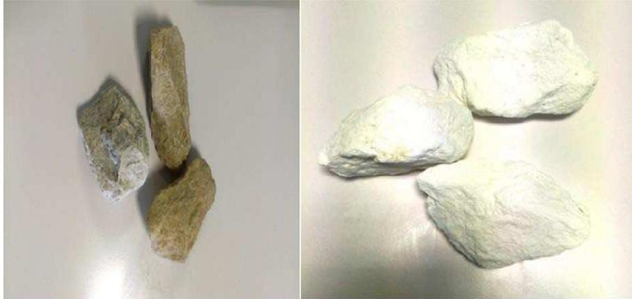
**Figure 18 :** Echantillons de calcaire de classe granulométrique de 40 mm à 70 mm calcine à 1000 °C.
