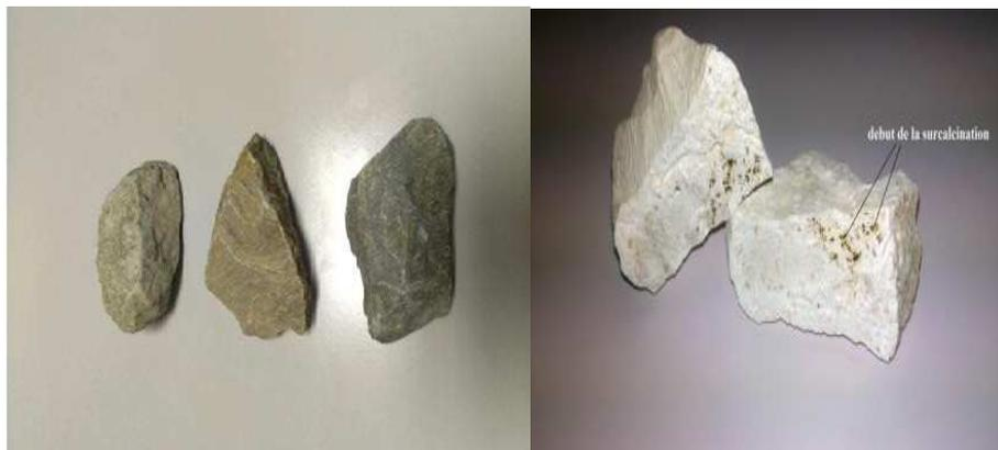
**Figure 19 :** Echantillons de calcaire de classe granulométrique de 40 mm a 70 mm calcinés à 1200°C.
