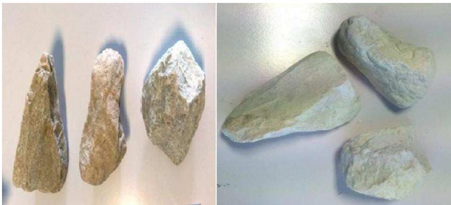
**Figure 17 :** Echantillons de calcaire de classe granulométrique de 40 mm à 70 mm calcinés à 800°C.
