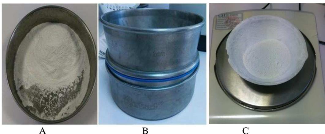
*Figure 12 : A : Refus de la chaux vive, B : Un tamis d'ouverture 2mm, C : Echantillon de chaux vive de granulométrie >2mm.*
