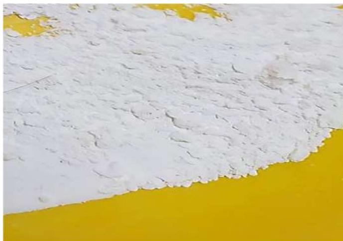
*Figure 22 : Chaux vive hydratée avec un excès d'eau, Cevital.*
