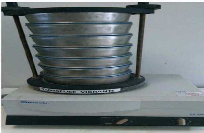
*Figure 13 : tamiseuse vibrante (laboratoire d'usine CEVITAL).*
