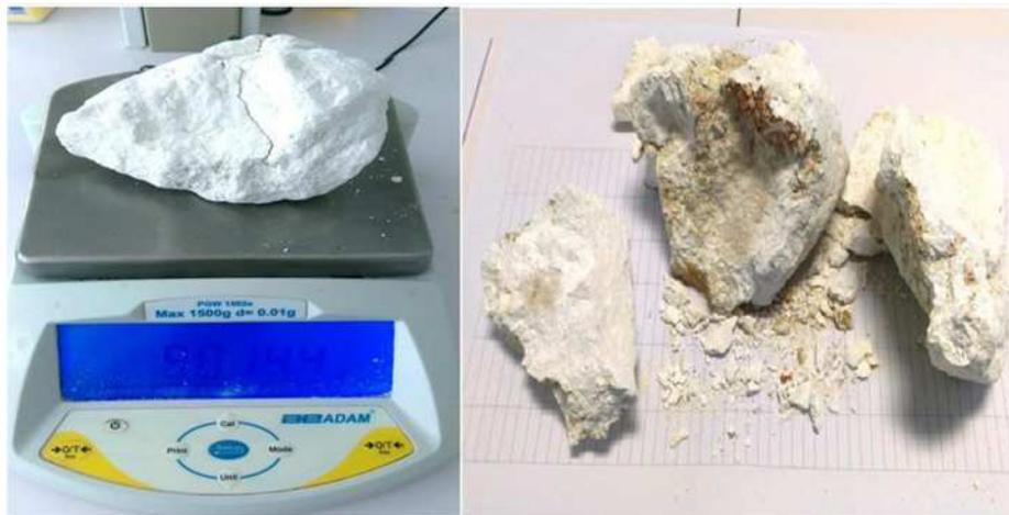
*Figure 11 : La classe supérieure à 70 mm avant et après calcination.*
