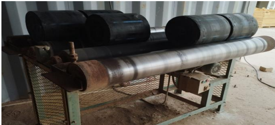
Figure II-8 : Test de bouteille roulante.[Photo prise 2023]
