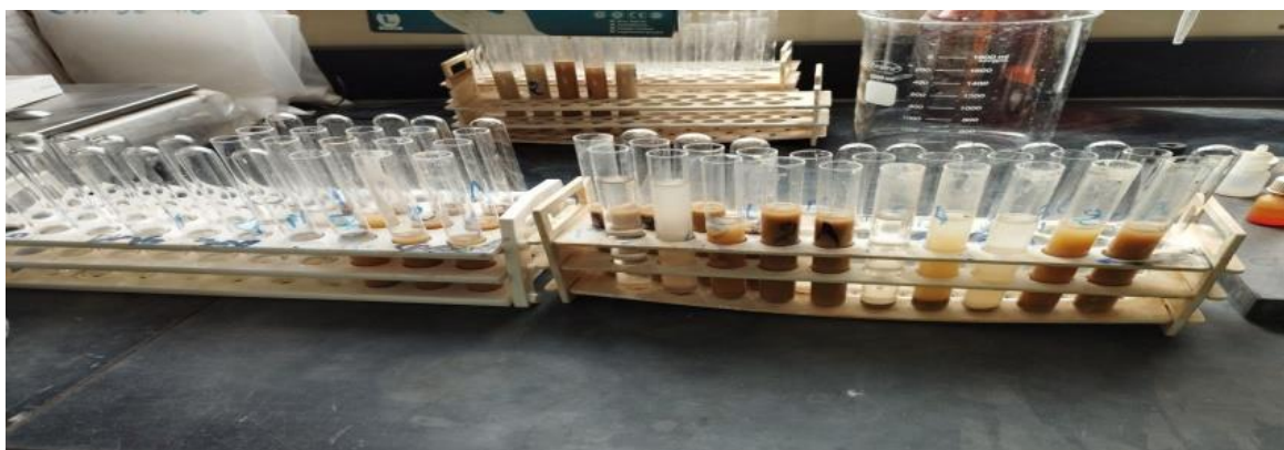
Figure II-12 : Tubes contenant les perles + \text{HNO}_3 sur le bain-marie pour préchauffer [photo prise 2023]
