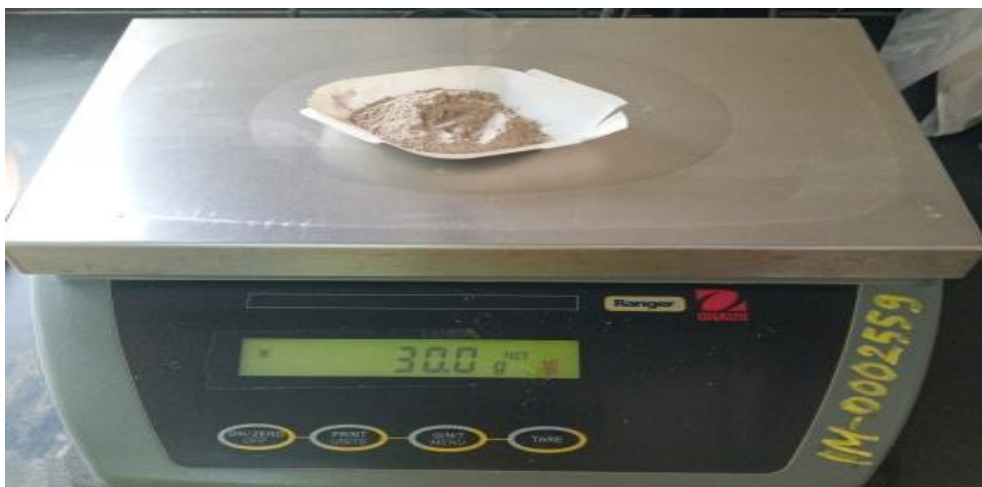
Figure II-9 : Pesage 30 g du minerai [Photo prise 2023]
