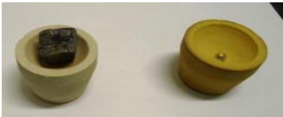
Figure II-11 : La deuxième fusion qui permet l'obtention des perles. 1
