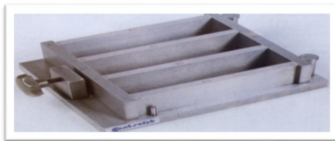
Figure II-2 : Le moule utilisé dans la préparation des monolithes.
