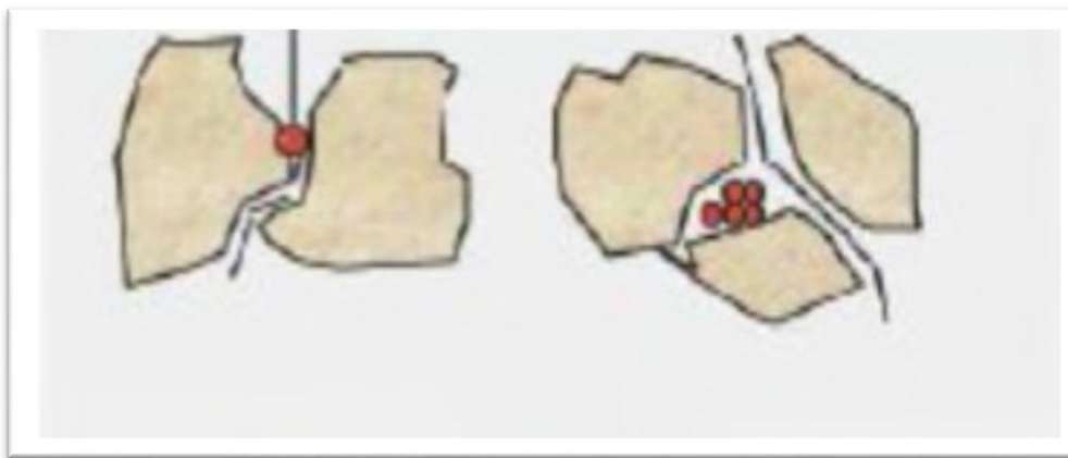
Figure I-7 : Piégage mécanique des métaux lourds
