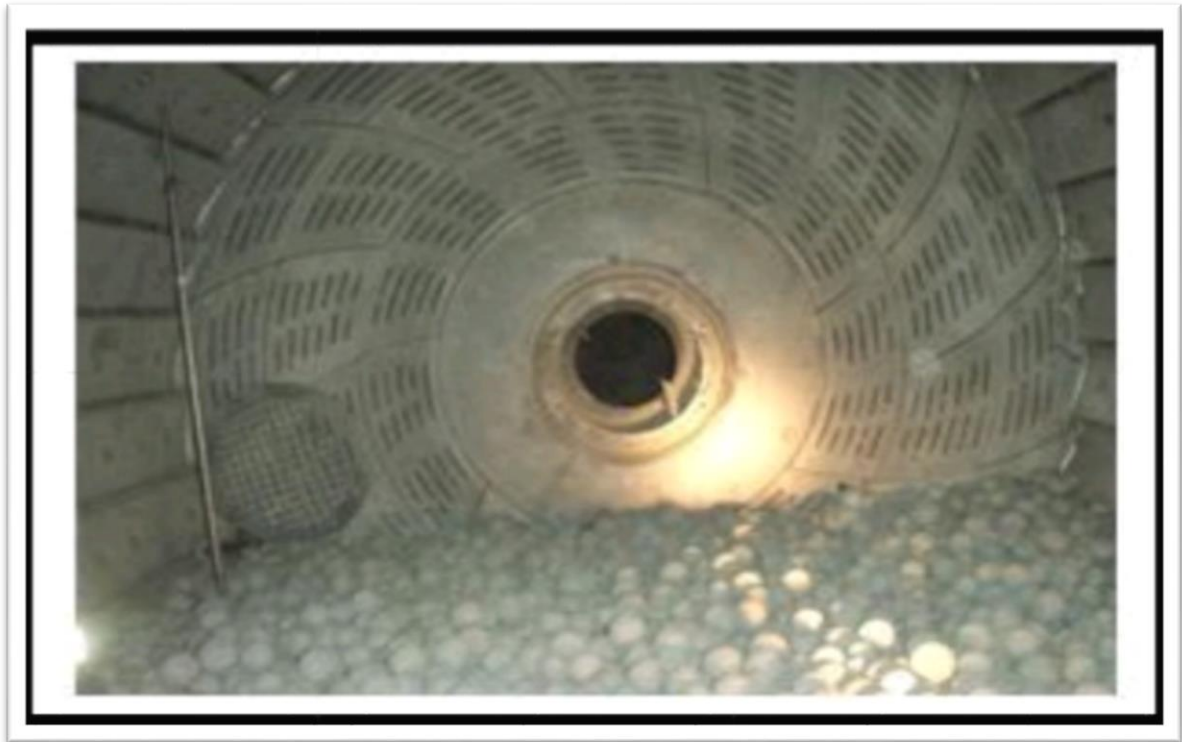
Figure I-2 : Intérieur d'un broyeur à boulets.
