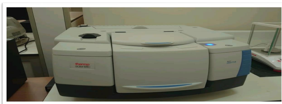
Figure II-6 : Image de l'appareil du spectrophotomètre IR.
