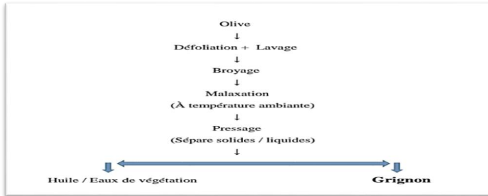
Figure I-5 : Obtention de grignon d’olive par le système de presse.[26]
