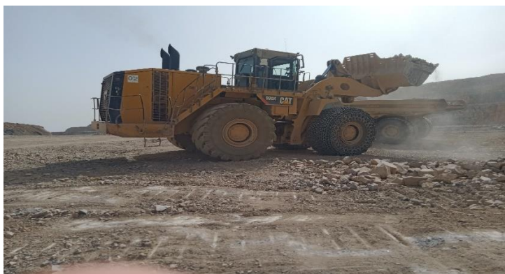
Figure II.8 : la chargeuse Caterpillar 990k utilisée.
