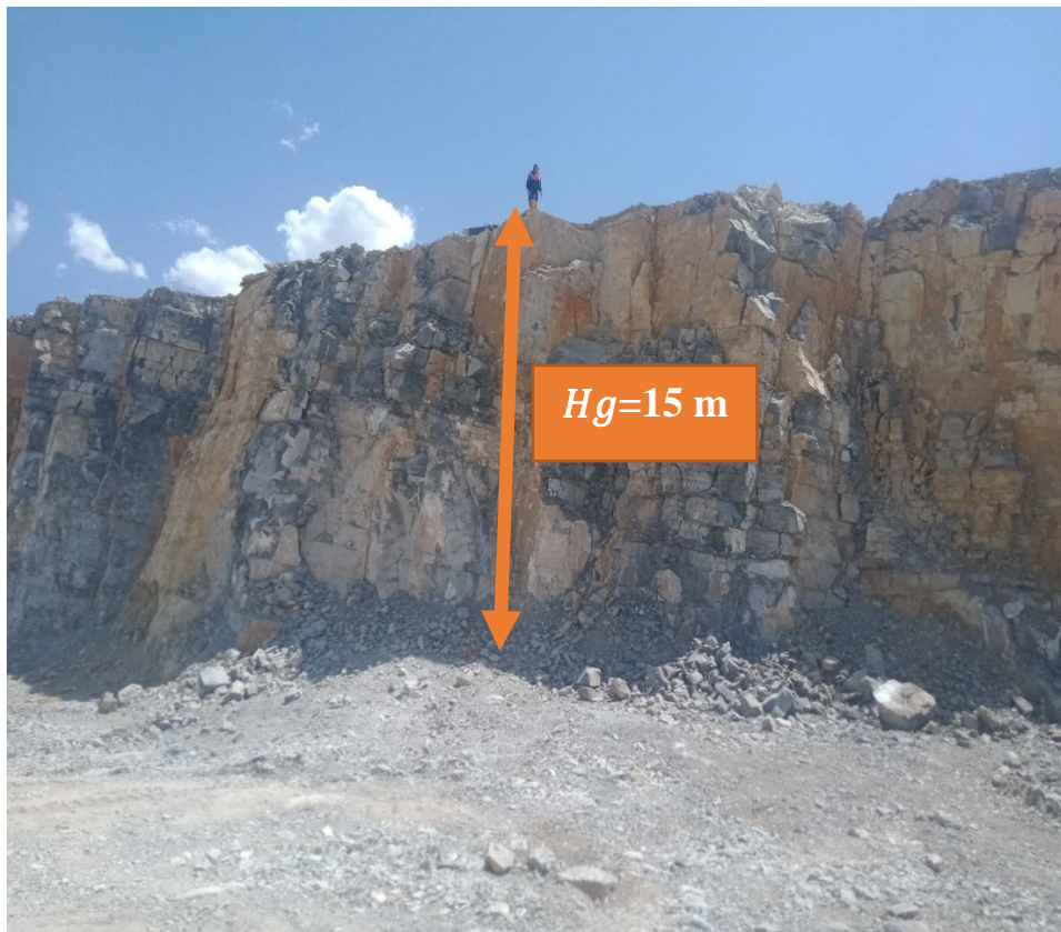
Figure II.5: hauteur du gradin de gisement du Djebel Medjounes.
