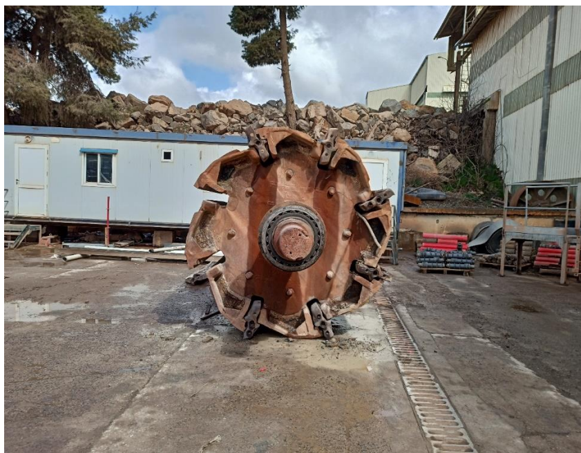
Figure II.10 : image montre marteau d'un concasseur
