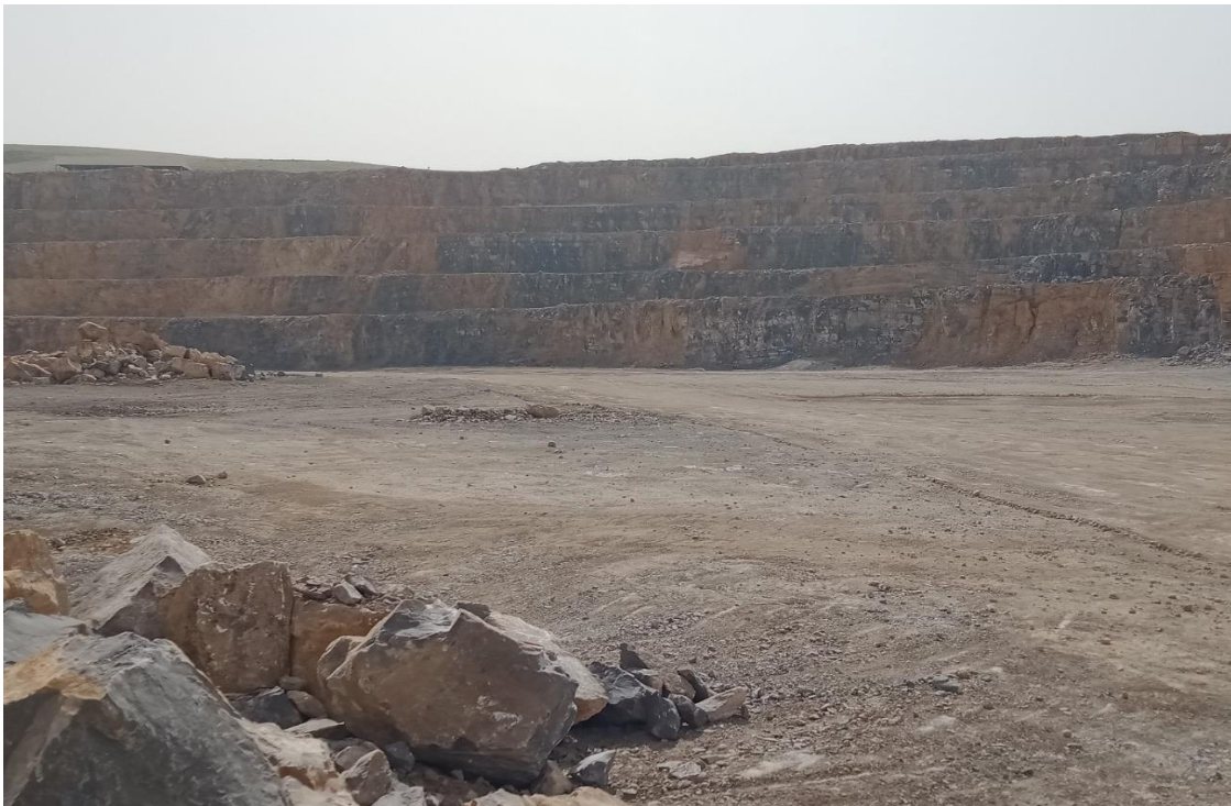
Figure II.4 : les gradins en exploitation de gisement du Djebel Medjounes.
