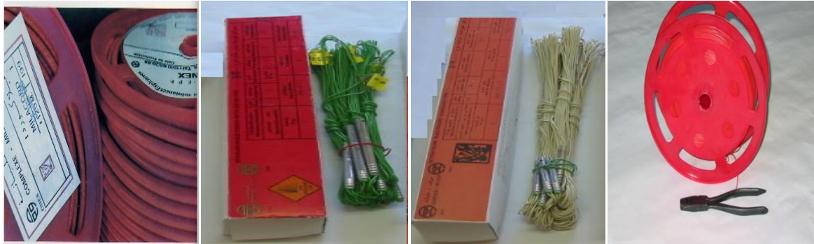
Figure III.2: Les accessoires de tir (cordant détonant, les détonateurs, le fil de tir).
