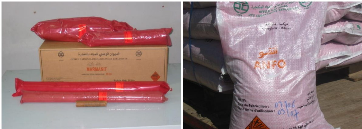
Figure III.1 : Marmanit III en cartouche et l'Anfomil en vrac dans les sacs de 25 Kg.
