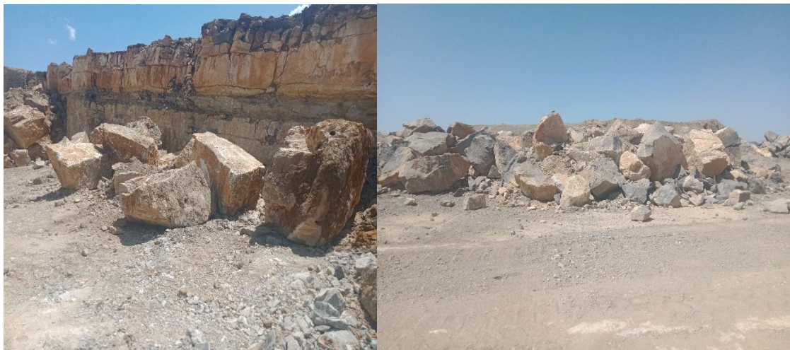
Figure II.13: Exemple des hors gabarit après le tir.
