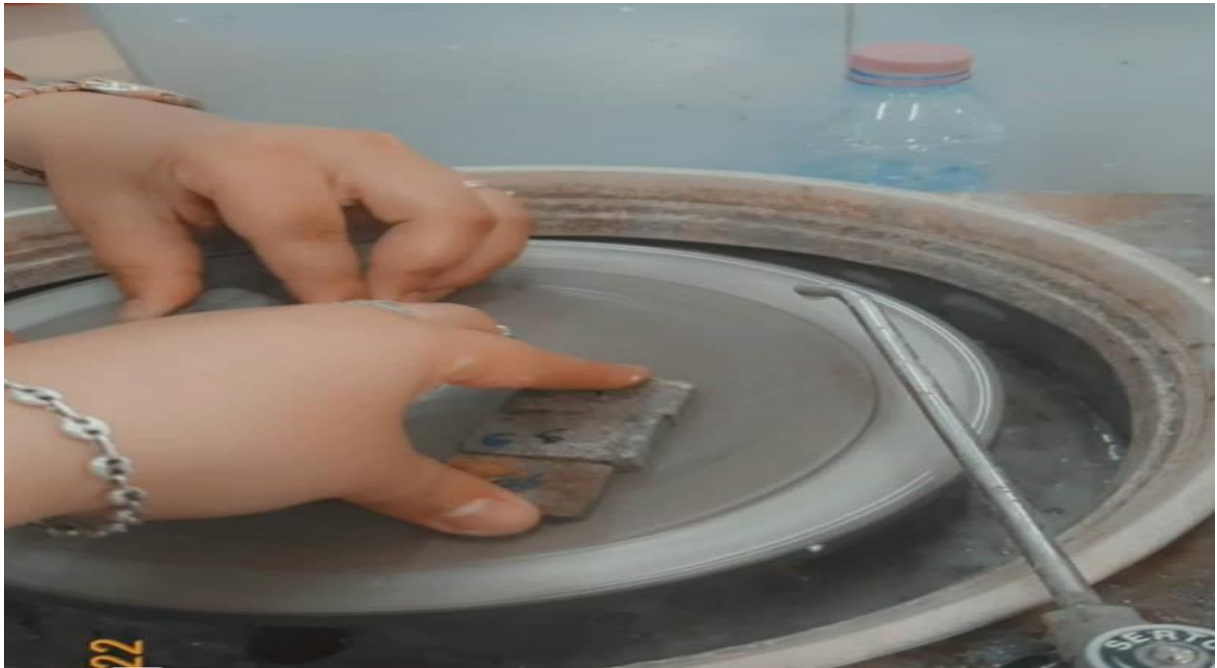
Figure IXIV.15 : Plateau tournant pour polissage de la section polie au département de géologie-univ setif (photo prise)
