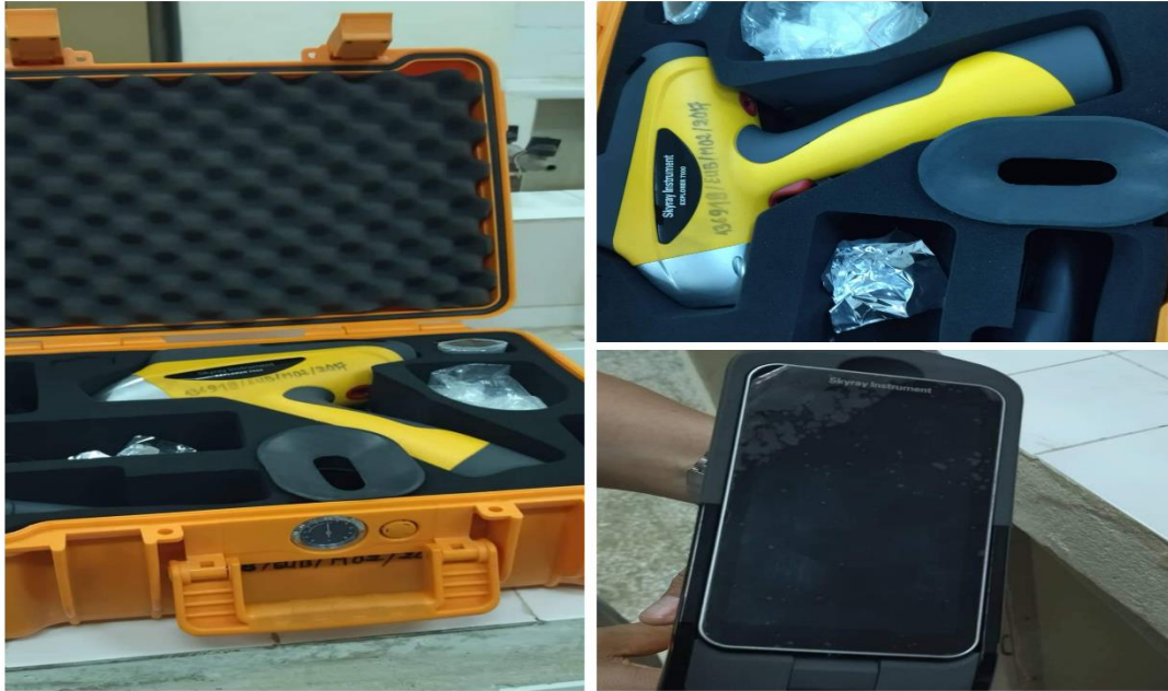
Figure IIX.10 : Appareil fluorescence rayon X au niveau de laboratoire LPCMC à l'université de Bejaia ( photo prise)
