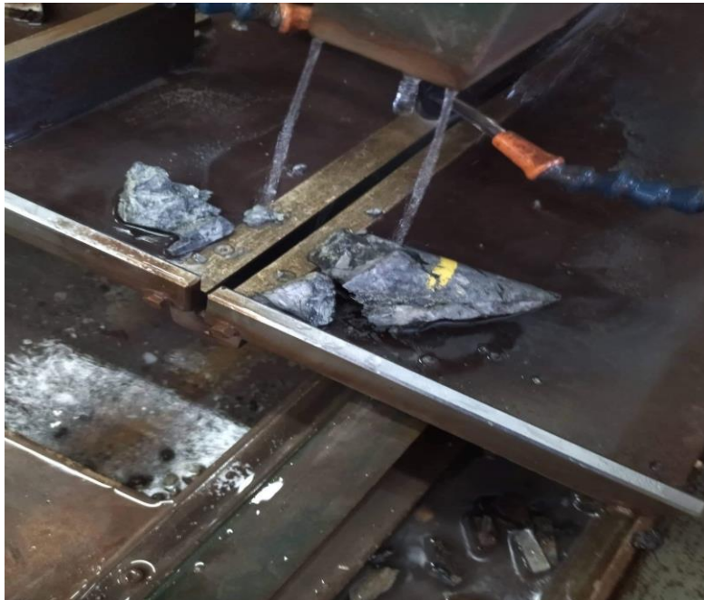
Figure IX.11 : Une scie circulaire diamantée doté d'un courant d'eau du département de géologie-univ setif (photo prise)
