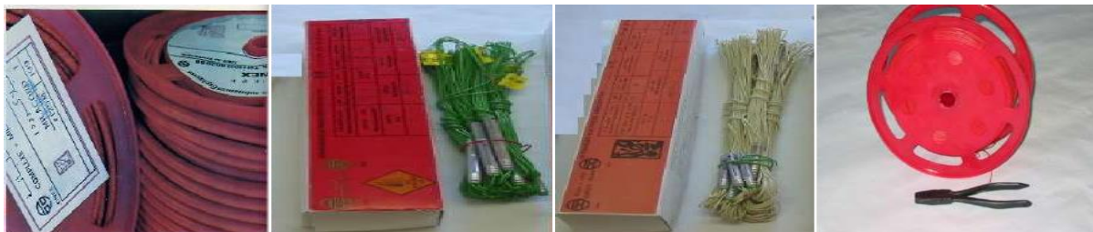
Figure I.1. Les accessoires de tir (cordant détonant, les détonateurs, le fil de tir). [2]
