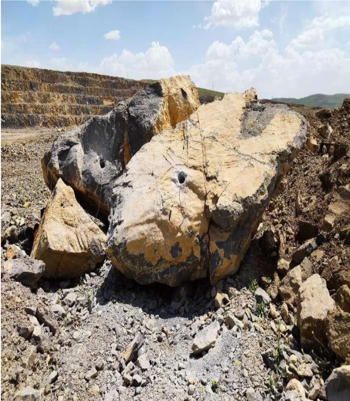
Annexe n ° 12. Images montre les roches hors gabarit existant à la carrière de Ain El-Kebira.
