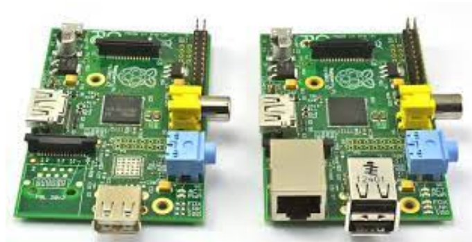
Fig. 1.10 : La carte Raspberry Pi modèle A (à gauche) et modèle B (à droite)
