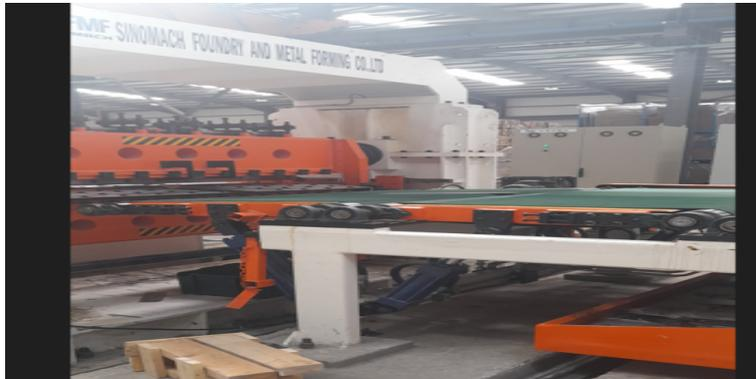
FIGURE 1.15 – Découpe horizontale de la sous-bobine de tôle à l'aide de la machine cut to length.
