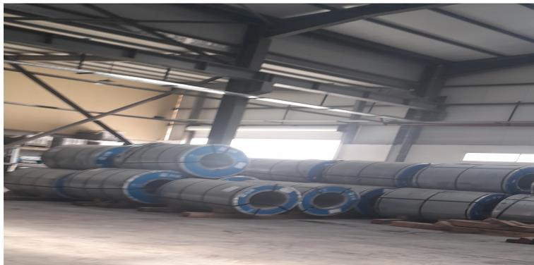
FIGURE 1.10 – Des rouleaux de matière première (des bobines).
