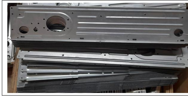
FIGURE 3.1 – Pièces fabriquées après plusieurs opérations sur une plaque métallique.
