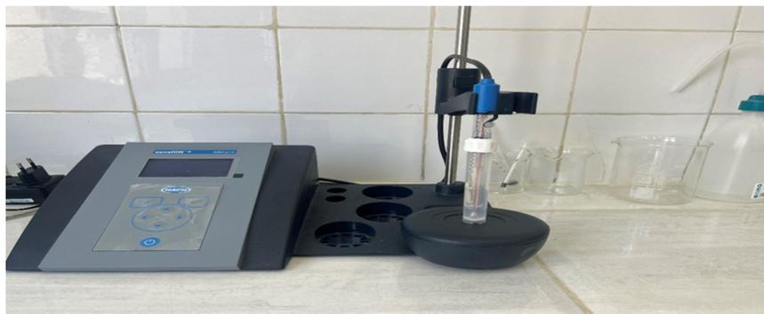
**Figure 2** : dispositif de mesure de PH.
