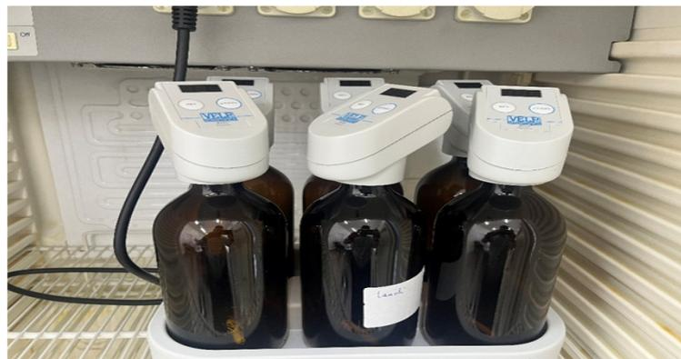
**Figure 4 :** dispositifs de DBO5
