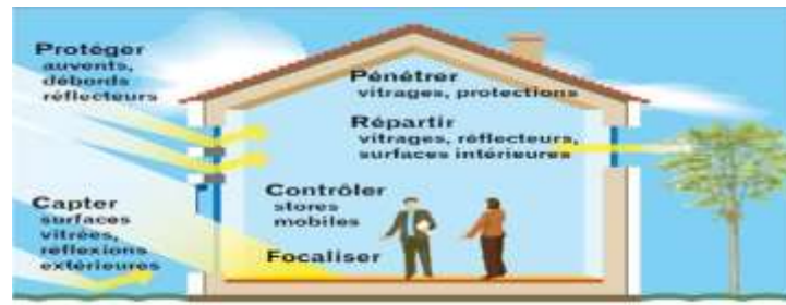
Figure 10 : Stratégies d'ouverture et de contrôle de la lumière naturelle/ source : traité d'architecture et d'urbanisme bioclimatique
