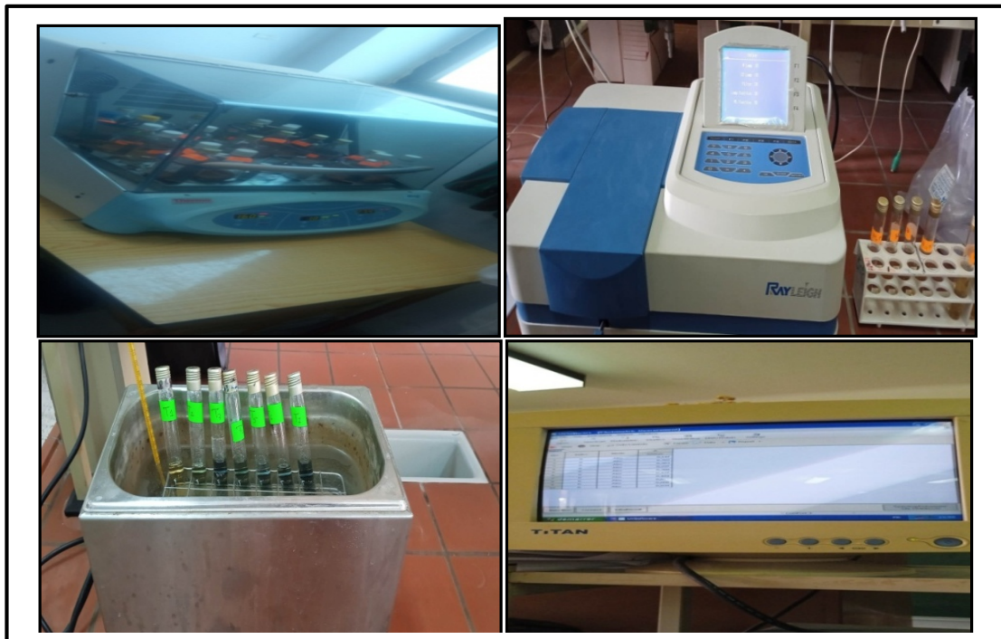
Figure n°09 : Etapes de dosage du Phosphore Assimilable dans le sol étudié ( photographie originale, 2023 ).
