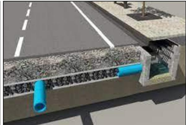
Figure 83 : Les noues d'infiltration avec tranchées drainantes
