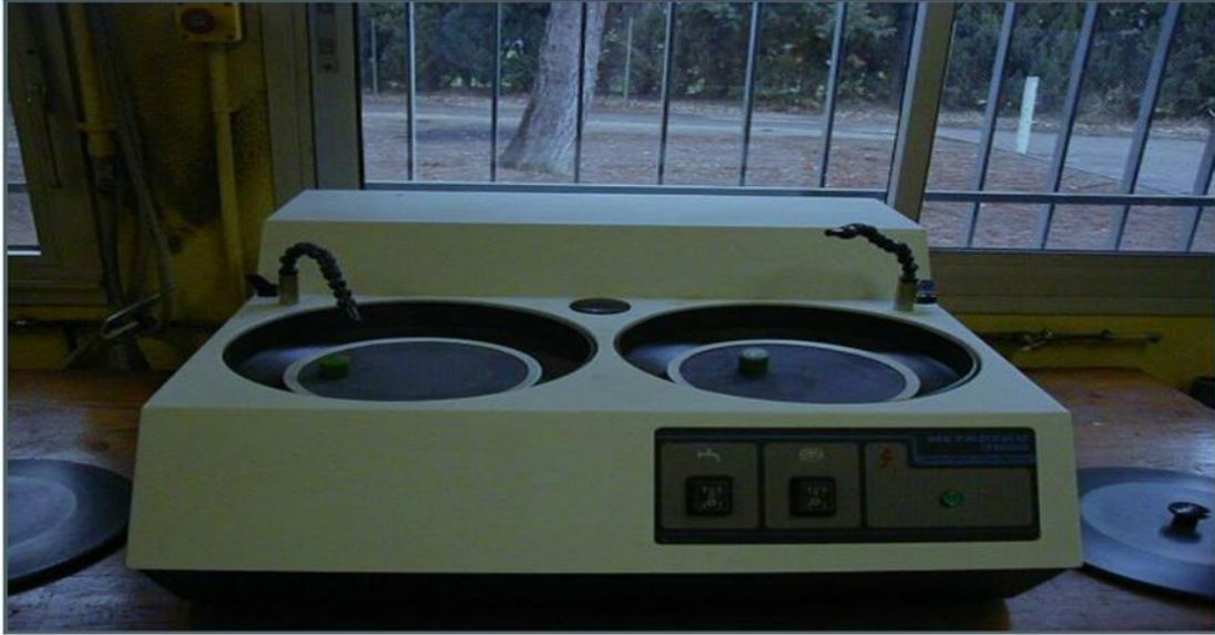
**Figure II.3:** Polisseuse mécanique à papier abrasif [14]
