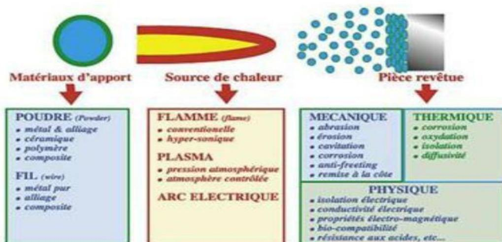
Figure I.4: principe de la projection thermique [6].
