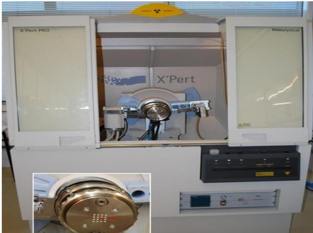
**Figure II.5:** Dispositif Diffraction X : X'PERT PRO MRD de chez PANalytical.
