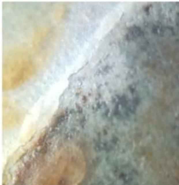
**Figure III. 14:** Image microscopique de dépôt après le test de corrosion (X400)
