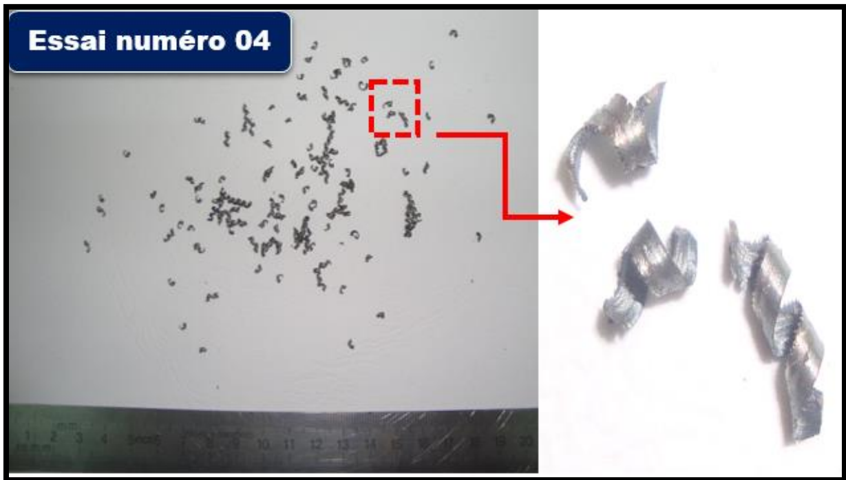
Figure 4.23 : Copeaux élémentaires enchevêtrés.
