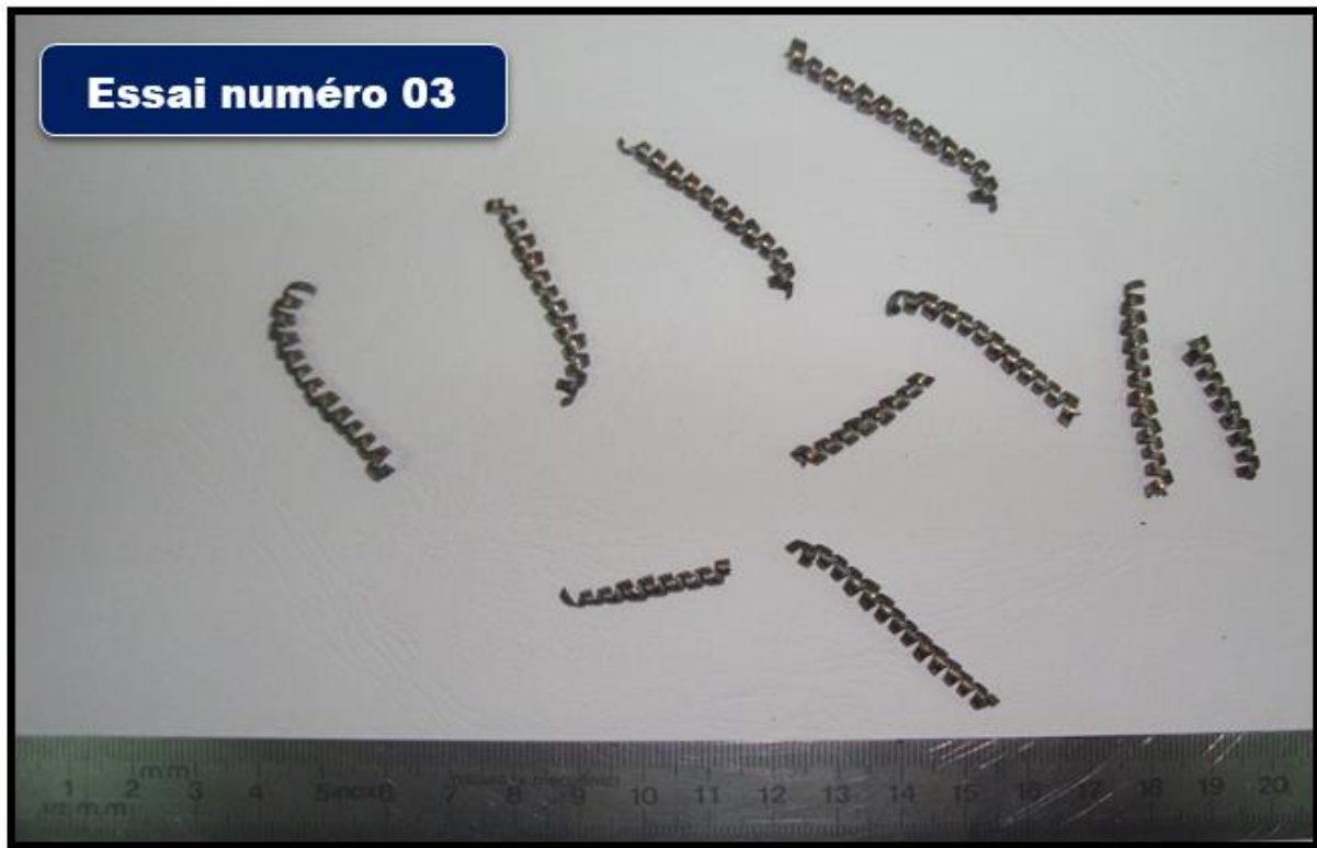
Figure 4.21 : Copeaux hélicoïdales en rondelles courts.
