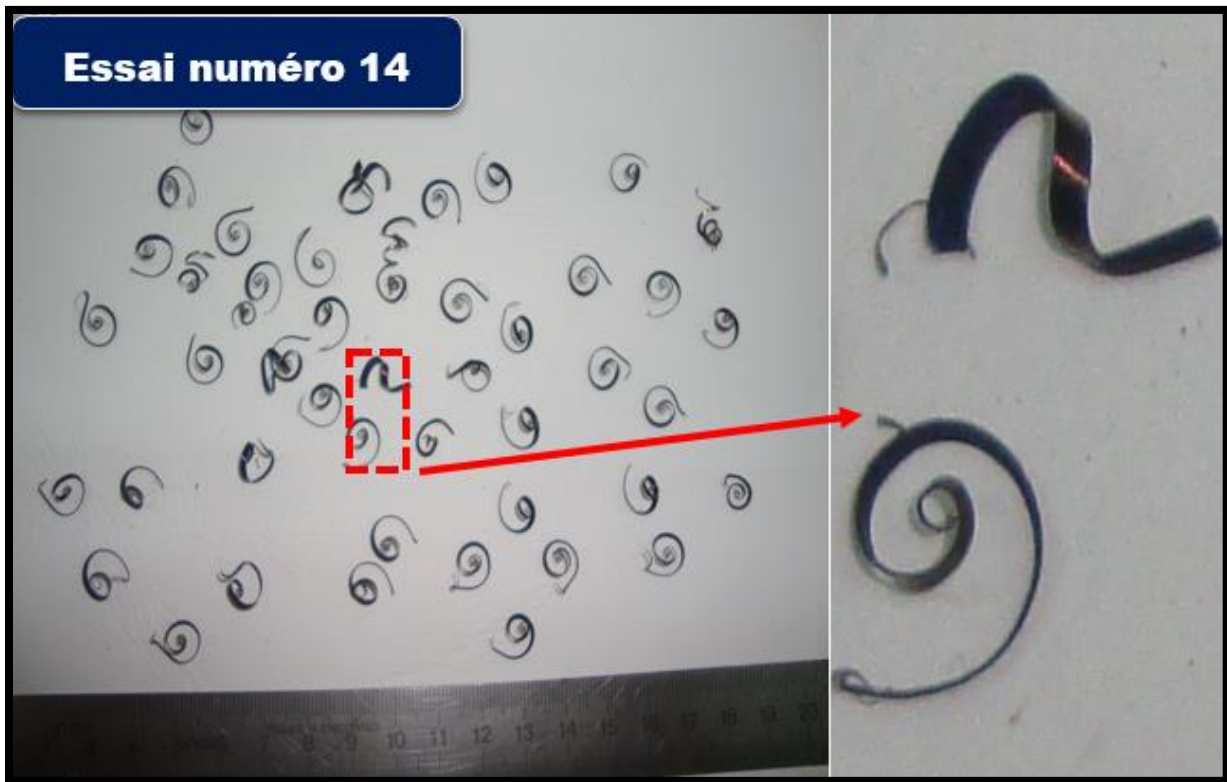
Figure 4.43 : Copeaux en spirales plats.
