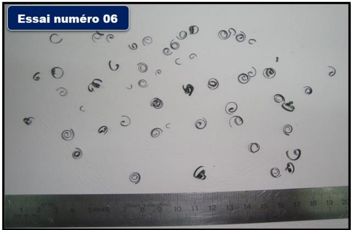
Figure 4.27 : Copeaux en spirales coniques.
