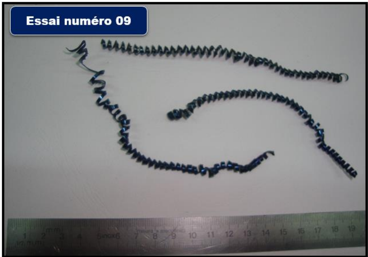
Figure 4.33 : Copeaux hélicoïdaux en rondelles longs.
