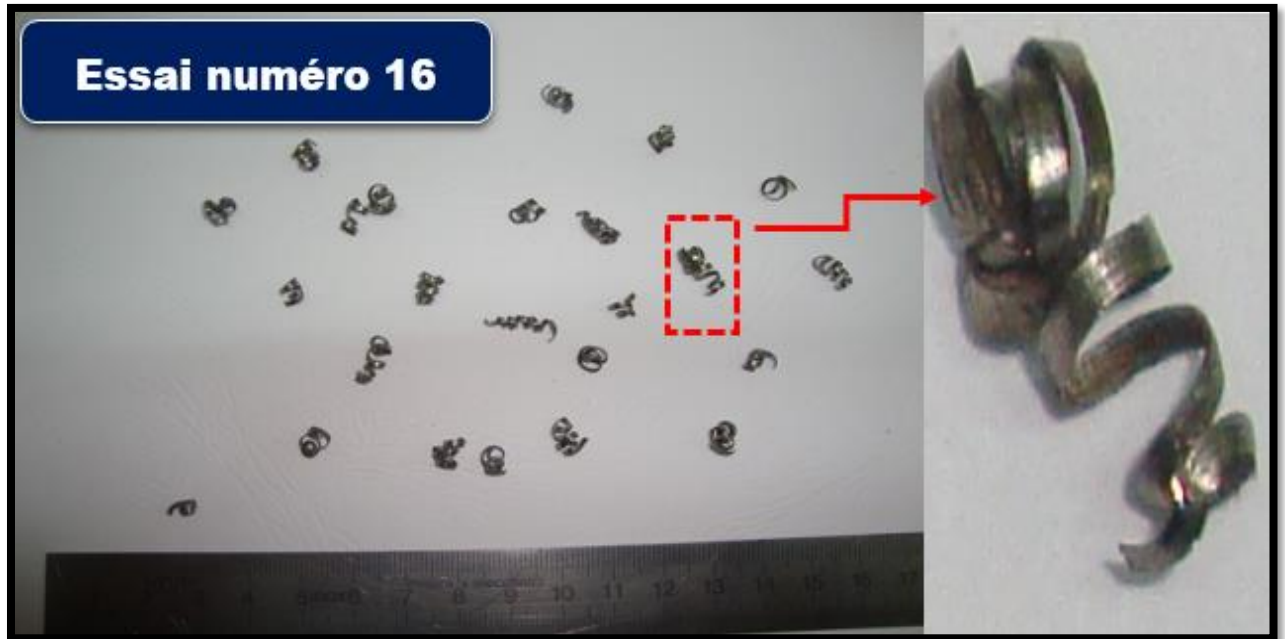
Figure 4.47 : Copeaux hélicoïdaux coniques courts.
