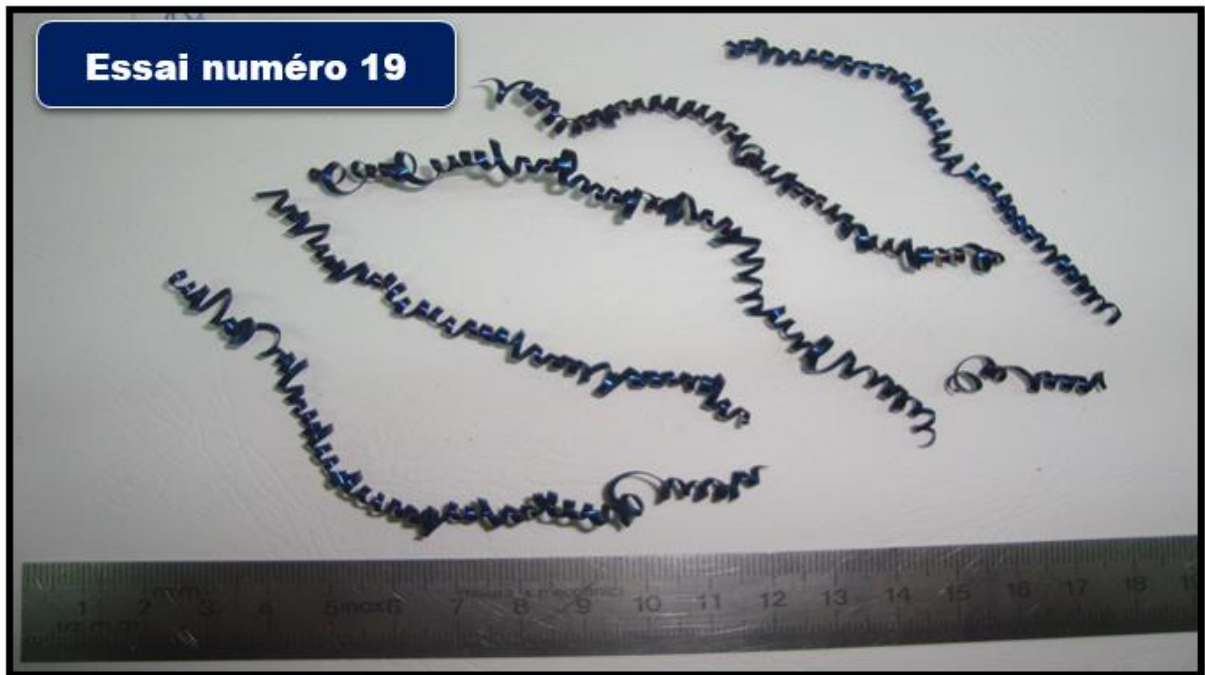
Figure 4.53 : Copeaux hélicoïdales en rondelles longs.
