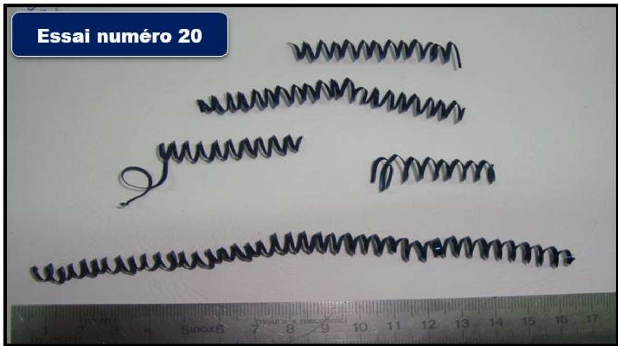
Figure 4.55 : Copeaux hélicoïdales en rondelles courts.
