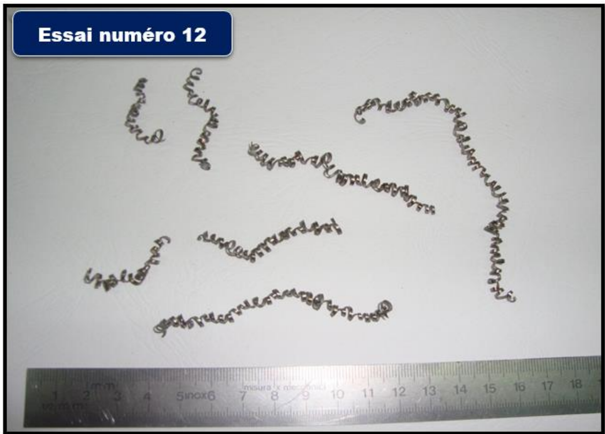
Figure 4.39 : Copeaux hélicoïdaux en rondelles.
