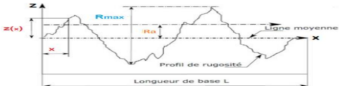
Figure 1.22 : Définition de la rugosité Ra (norme ISO 428). [6]
