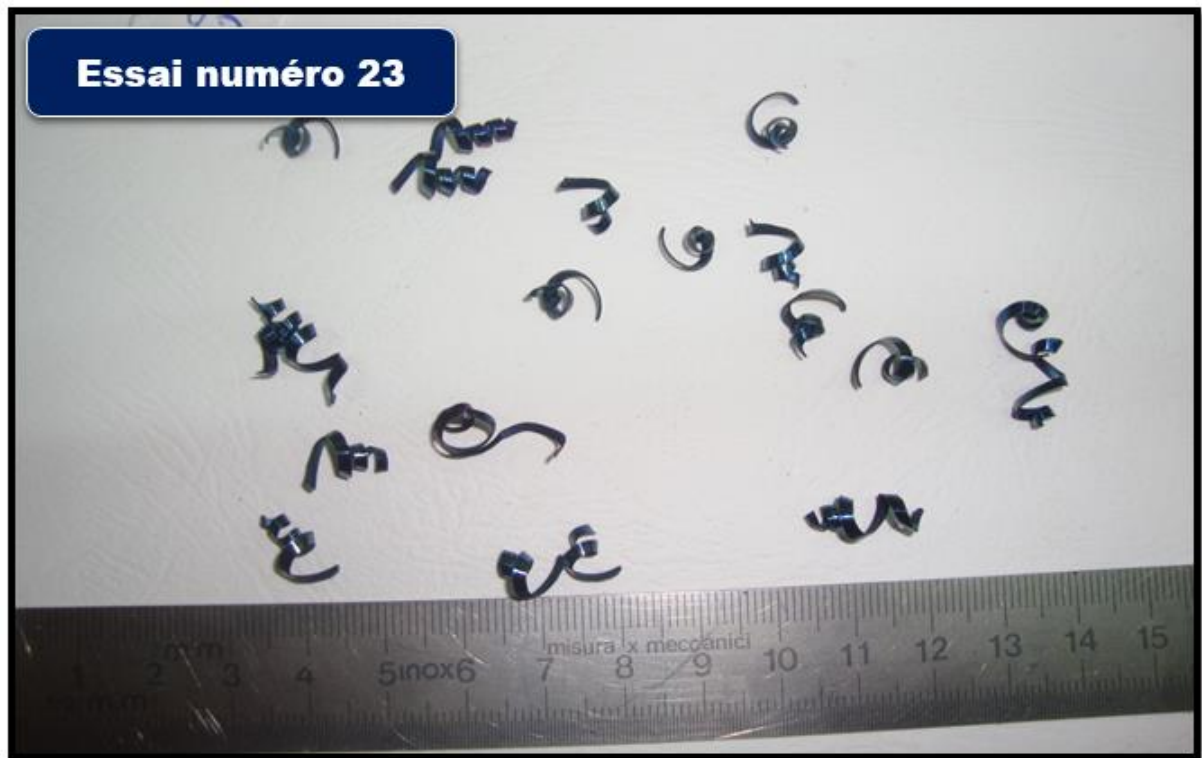
Figure 4.61 : Copeaux élémentaires enchevêtrés.
