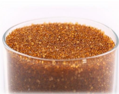
Figure I.13 : Illustration des résines échangeuse d'ions.
