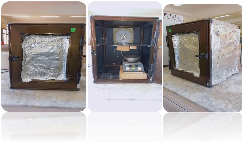
Figure II.1. Montage utilisé pour le traitement photo-catalytique
