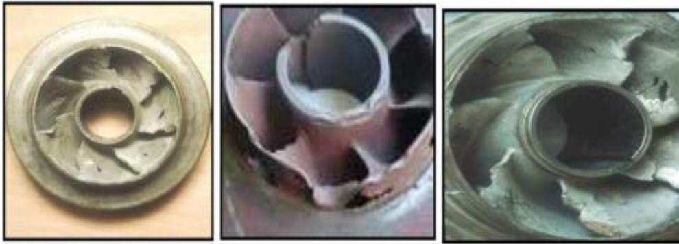
**Figure V.10: Photos illustrant le phénomène de cavitation sur des aubes de pompe centrifuge [8]**
