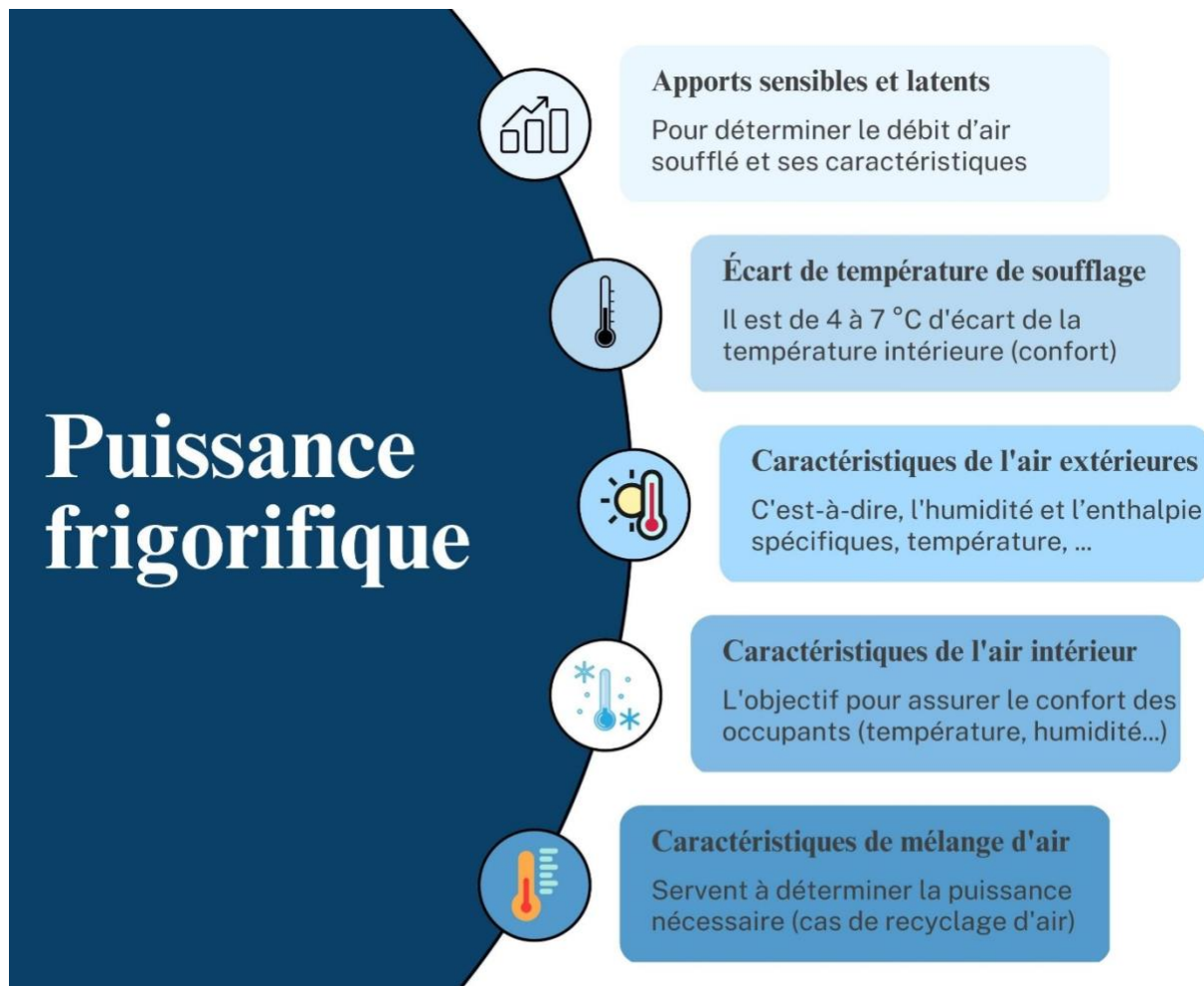
Figure II.1 : étapes de détermination de la puissance frigorifique.
