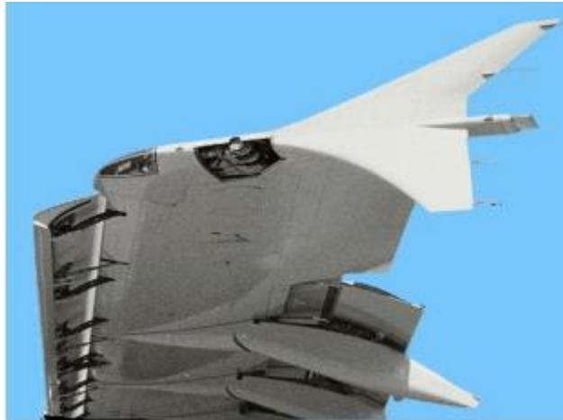
**Figure II.10 :** Les dispositifs hypersustentateurs de bord d'attaque, et de bord de fuite [20].
