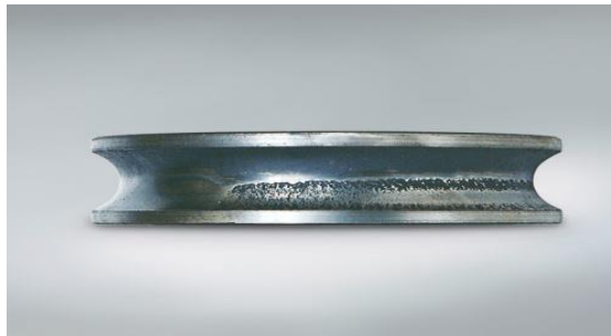
Figure I-04 : écaillage sur une bague intérieure d'un roulement à billes à contact oblique [07]
