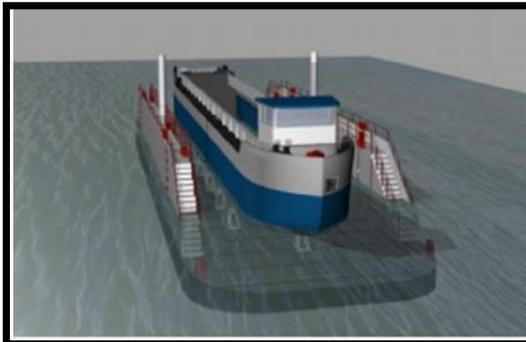
Figure I.5 : Entrée du bateau sur fin du déballastage
