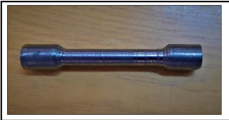
Figure II.11 : Eprouvette de traction après tournage.
