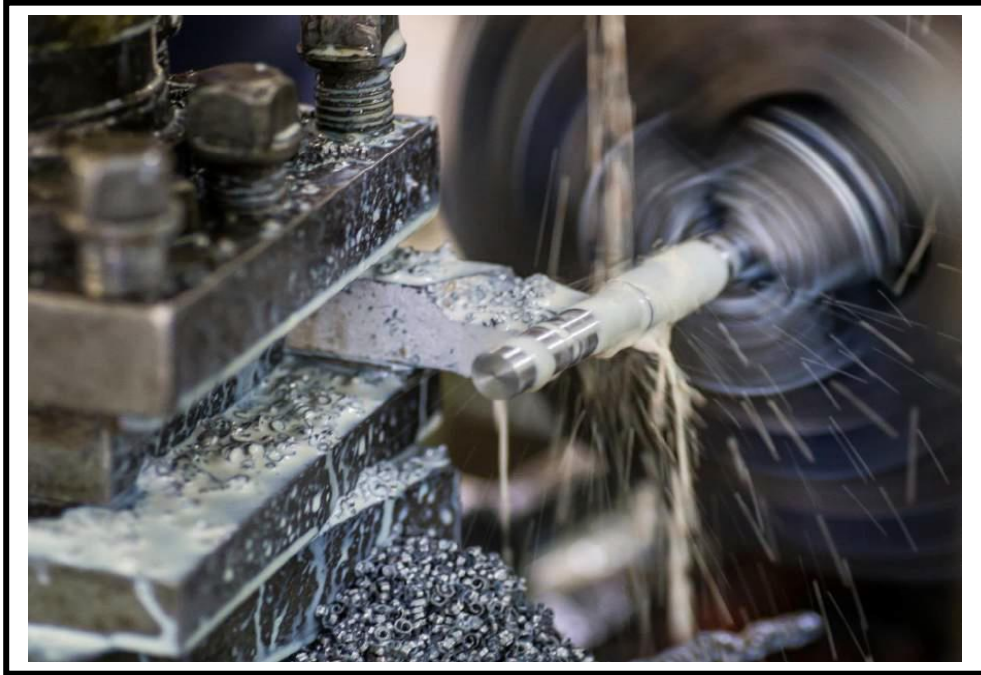
Figure II.10 : Usinage de l'éprouvette de traction par tournage.
