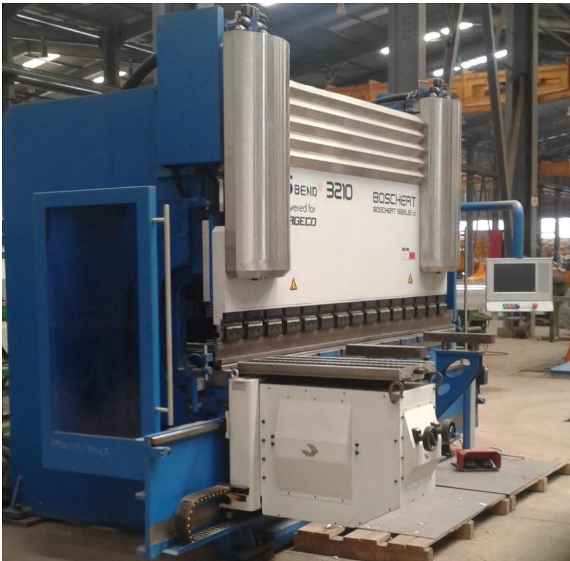
Fig 1. 4 : Presse plieuse hydraulique BOSCHERT G-BEND 3210.
