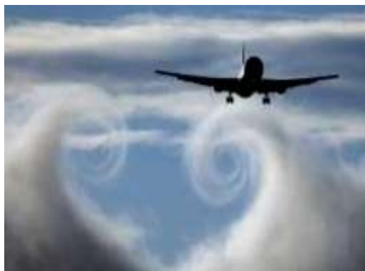
Figure II.29 : Visualisation des tourbillons marginaux à travers d'un nuage fumée.
