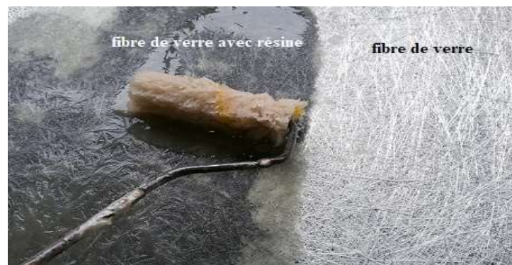
Figure III.46 : Moulage avec fibre de verre et résine.
