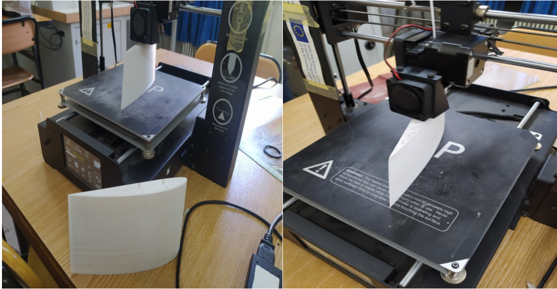
Figure III.40 : Exemple d'impression de profil avec l'imprimante 3D Monoprice Maker Select Plus.
