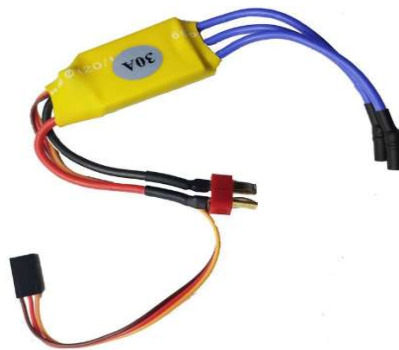
Figure I.37 : ESC 30A (contrôleur de vitesse électronique).
