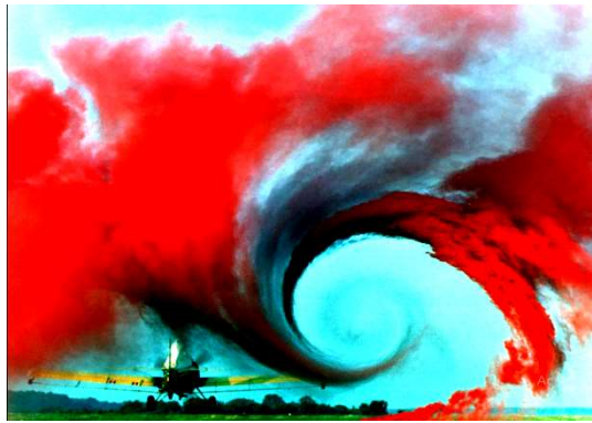
Figure II.28 : Visualisation des tourbillons marginaux en colorant l'écoulement en bout d'aile.
