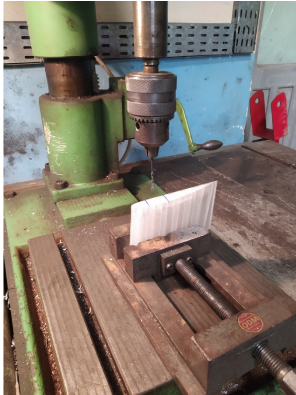
Figure III.41 : Perçage de différentes parties de l'aile et d'empennage.
