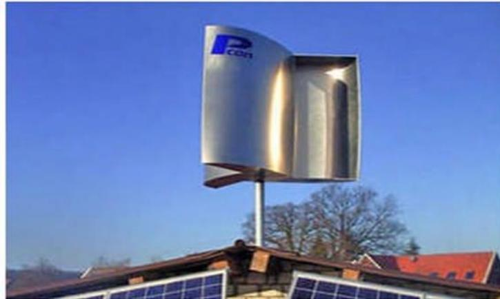
**Figure I.2:** Eolienne Savonius sur une toiture.
