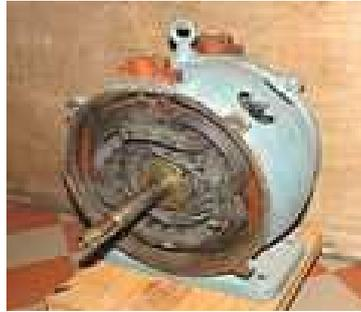
**Figure (II.2) :** Le stator, 4 paires de pôles. Les deux borniers de raccordement.
