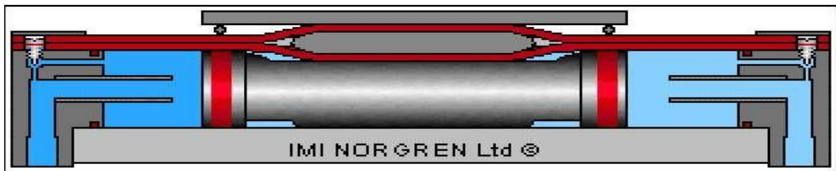
Figure I.28: Exemple d'un vérin double effet sans tige avec amortissement des deux côtés [5]
