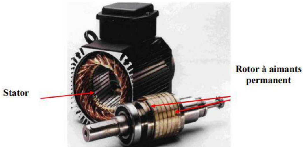
Figure I.1 Représentation d'une machine synchrone à aimants permanents [14]
