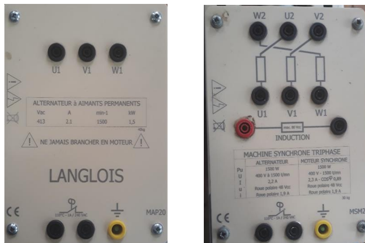
Figure III.1 Plaques signalétiques des deux machines : de la MSAP étudiée et du moteur d'entraînement
