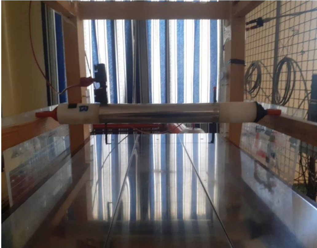
Figure II.8 Vue longitudinale du dispositif d'électrodes de la configuration Duale-Plan.
