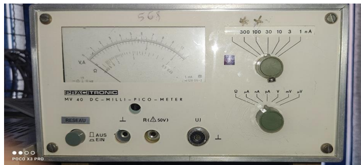
Figure II.13 Pico-ampèremètre à aiguille utilisé dans la mesure du courant de la sonde.
