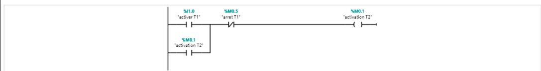
Réseau 8 : Transmetteur de niveau du la cuve de la remplisseuse 2
