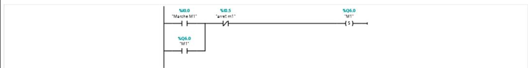
Réseau 2 : Activation de transmetteur de niveau de la cuve de la remplisseuse 1
