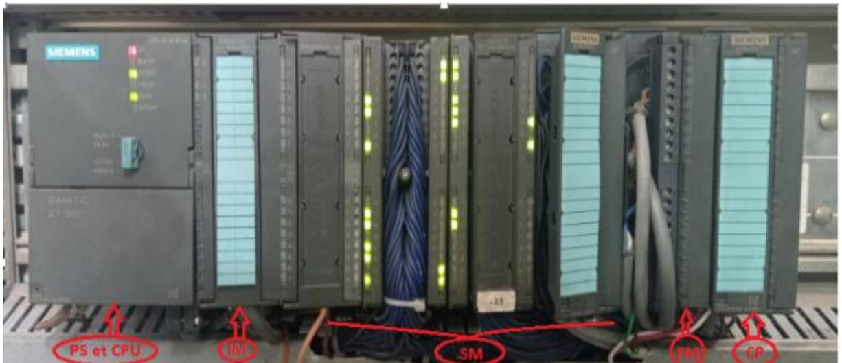
**Figure II.19:** Modules d'un API S7-300
